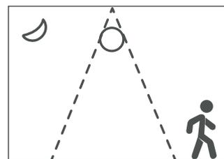
Quando no haya movimiento dentro del área de detección la luz se apagará automáticamente.
