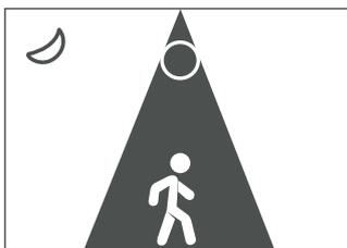
Quando haya movimiento dentro del área de detección la luz se encenderá automáticamente.
