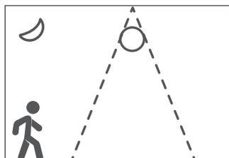
La luz no se encenderá si no hay movimiento dentro del rango de detección.
