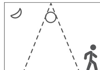
Cuando no haya movimiento dentro del área de detección la luz se apagará automáticamente.
