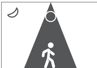
Cuando haya movimiento dentro del área de detección la luz se encenderá automáticamente.
