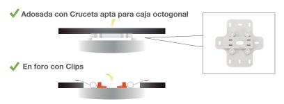
\*Indispensable para un buen funcionamiento contar con línea fase y neutro (en cableado) de no ser así se acortará el tiempo de vida de la luminaria, presentará parpadeo o no se apagará al 100%.
